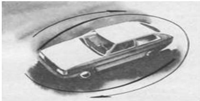
**Рис. 4. Рух автомобіля при аварійному гальмуванні обертанням**
