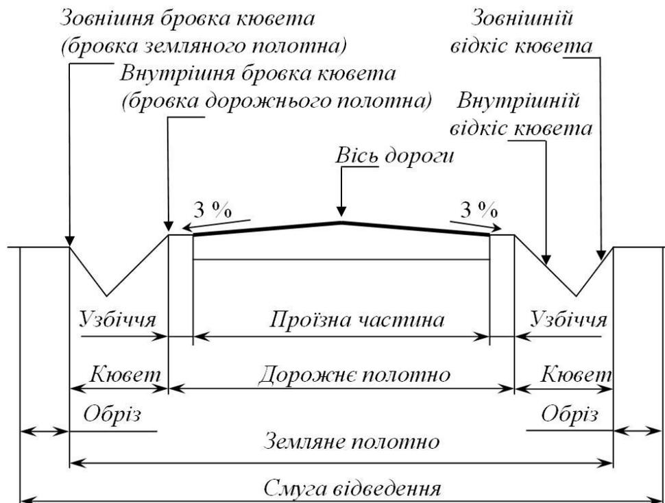
**Рис. 20. Основні елементи конструкції військових автомобільних доріг**
