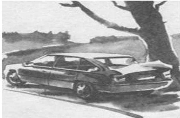
**Рис. 5. Момент ковзаючого удару об перешкоду при аварійному контактному гальмуванні**
